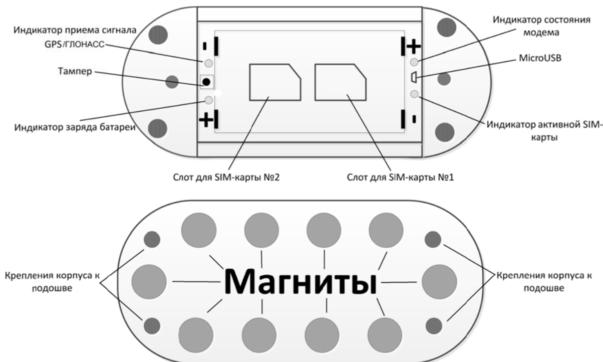
Рисунок 1. Верхняя часть прибора при открытой крышке и нижняя часть прибора – подошва с установленными магнитами (для версии «Voyager 5N M») 3
